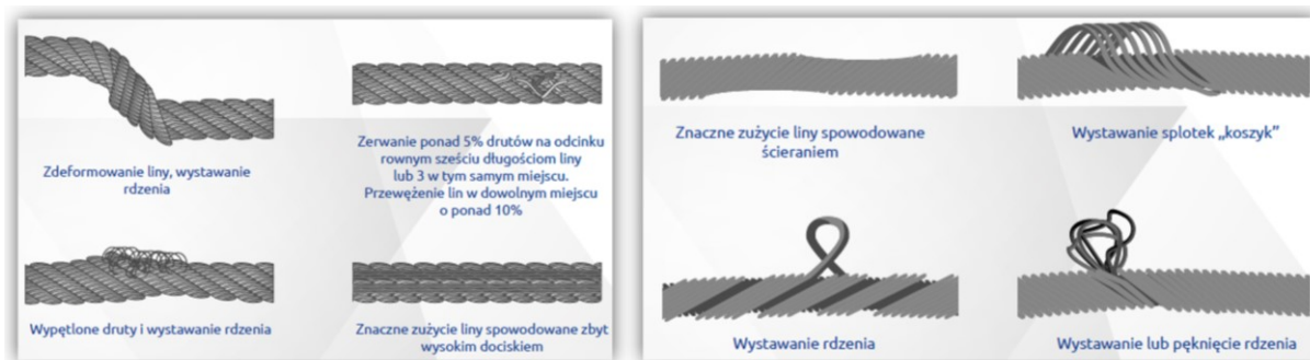
Rysunek 21 Zawiesia linowe – znamiona uszkodzeń
