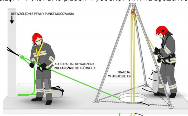
Rysunek 13 Przykład organizacji i zabezpieczenia prac wykonywanych w przestrzeni zamkniętej
