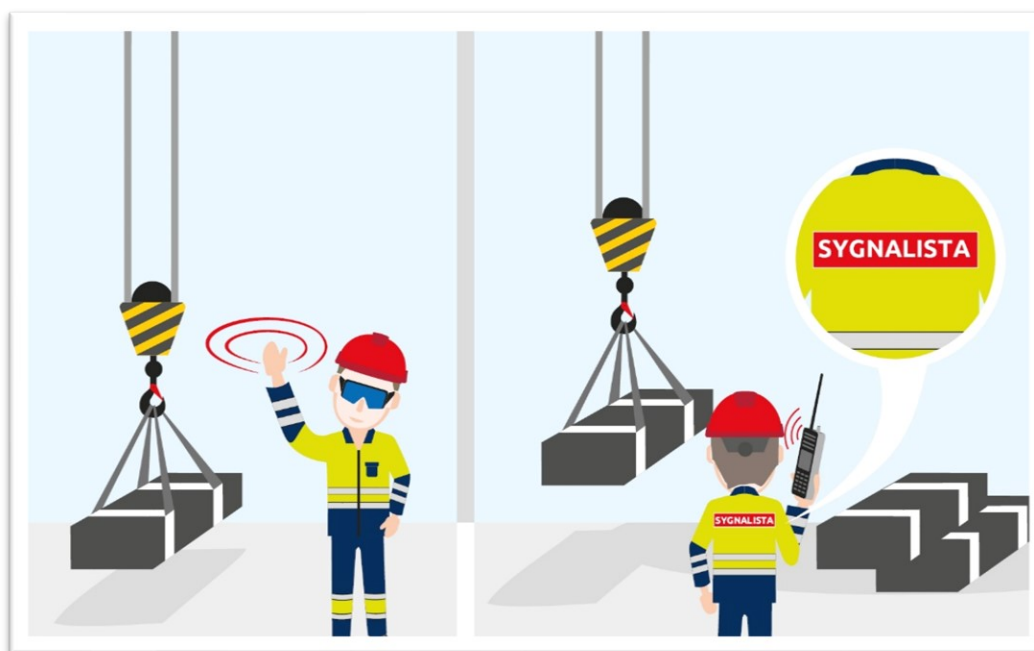
Rysunek 23 Komunikacja sygnalisty z operatorem urządzenia dźwignicowego.
